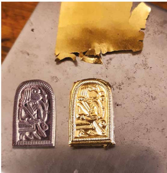
Fig. 2: Illustration, der viser processen med udhamring over en form, en såkaldt patrice. Til venstre ses patricen, og til højre er der hamret guldblik over patricen. Motivet præges på denne måde i guldet. Foto og guldbearbejdning: Mathias Vidas Olsen.
